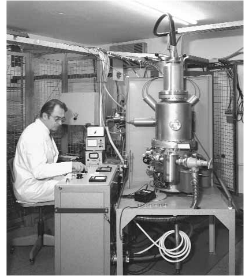
Erste Ionenimplantationsanlage für verschiedene Ionen in Deutschland wird am IEW in Betrieb genommen.
