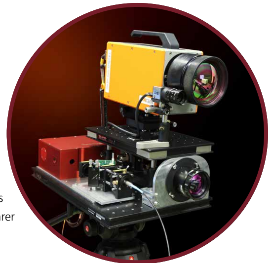
Messaufbau zur Ferndetektion chemischer Stoffe.
