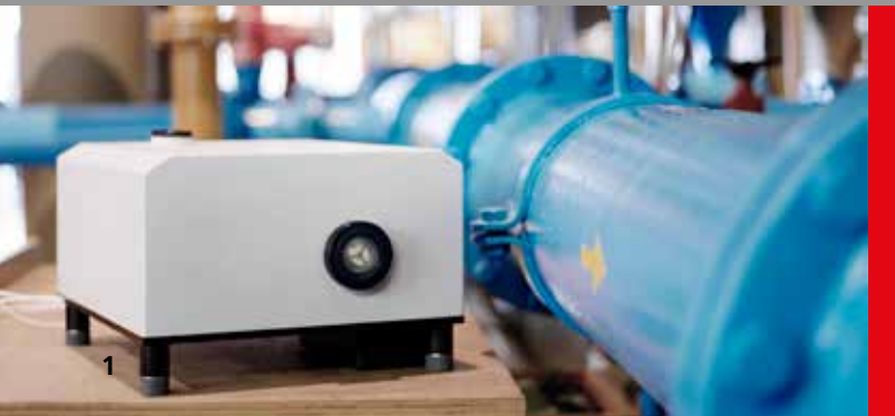
1 Nur wenig größer als ein Schuhkarton: Das System analysiert Wasserproben direkt am Werk.
